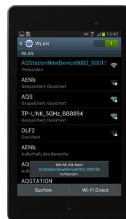
6. Vergewissern Sie sich, dass Sie mit dem „AQStationNewDevice...“-Netzwerk verbunden sind.
